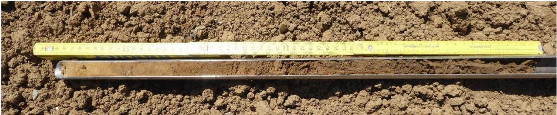
Abbildung 20: Bohrstockprofil 3 Kolluvium über Pararendzina
