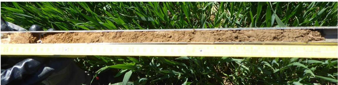
Abbildung 26: Bohrstockprofil 9 Kolluvium über Rendzina
