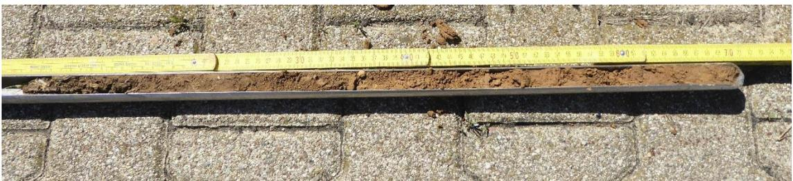
Abbildung 27: Bohrstockprofil 10 Kolluvium
