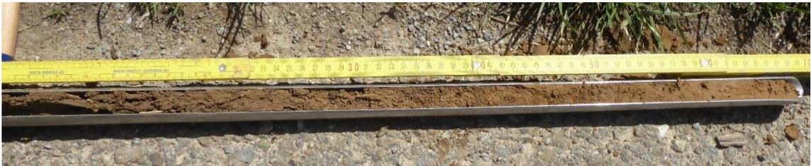
Abbildung 19: Bohrstockprofil 2 Kolluvium über Braunerde
