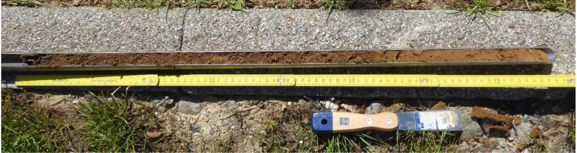
Abbildung 28: Bohrstockprofil 11 Kolluvium
