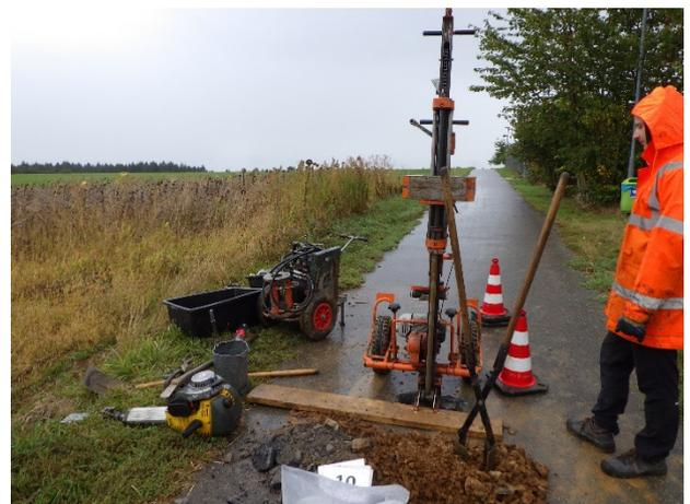
Foto 12: Rammsondierung bei RKS 10 / DPH 3
