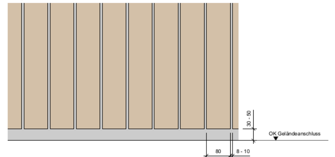
Detail Ansicht Holzfassade M 1:5
